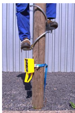
Dynamiskt övervar kningsinstrument som varnar vid för hög belastning.
